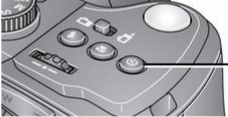
Pulse el botón de toma secuencial varias veces para desplazarse por los modos de disparador automático o de captura en ráfaga. El modo de flash activo aparece en la pantalla LCD o en el visor electrónico.
