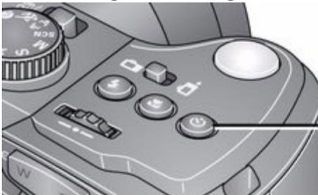
Pulse el botón de toma secuencial varias veces para desplazarse por los modos de disparador automático o de captura en ráfaga. El modo de flash activo aparece en la pantalla LCD o en el visor electrónico.
