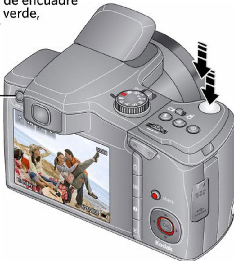
Para ahorrar energía de la pila, pulse el botón EVF/LCD (visor electrónico/pantalla LCD) y utilice el visor electrónico.
